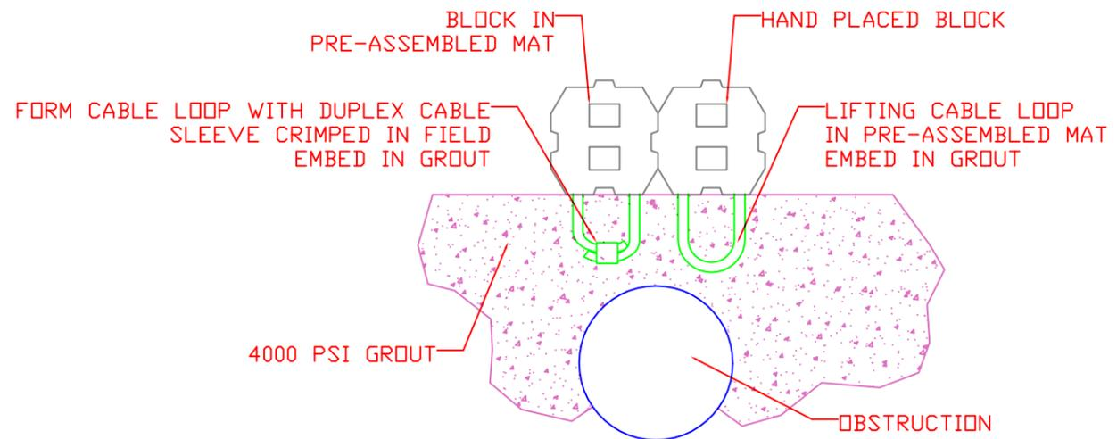
LONGITUDINAL (LIFTING) CABLE CONNECTION TO GROUT
